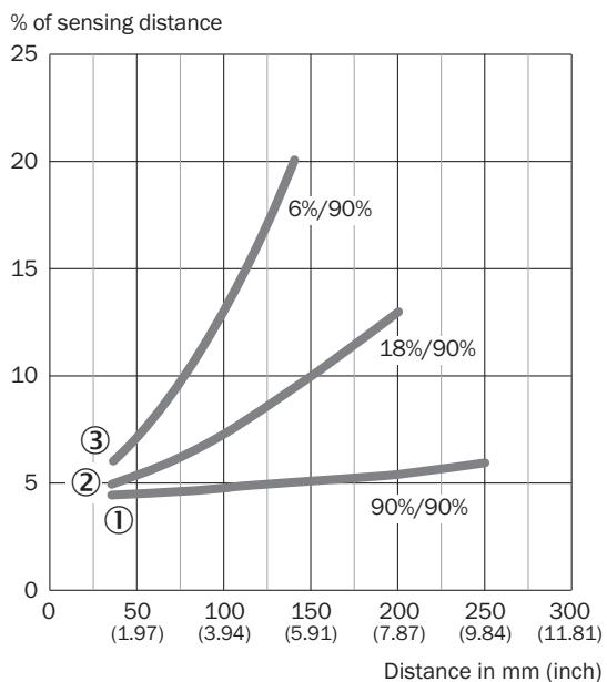
① Objet avec un coefficient de réflexion diffuse de 90 % (par rapport au blanc standard selon DIN 5033)
